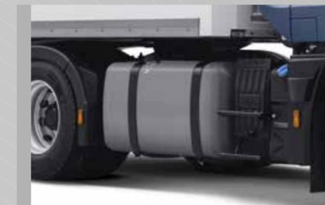
Un réservoir supplémentaire de 450 litres peut être ajouté au réservoir en aluminium de 600 litres dans la version de série du véhicule 4x2.
