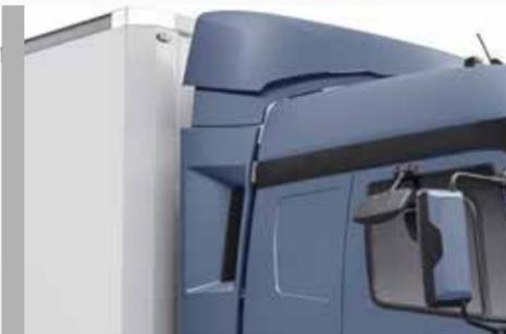
L'aileron qui capte le regard, le carénage rabattable et le déflecteur avant minimisent la résistance au vent du véhicule, améliorant ainsi les économies de carburant et l'esthétique.
