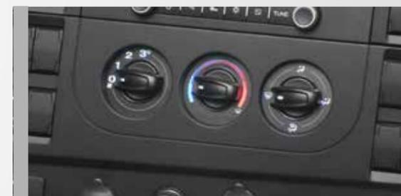
Le système de contrôle climatique amélioré (climatisation) est un équipement de série sur tous les véhicules. Il assure le confort du conducteur en maintenant la température idéale dans diverses conditions météorologiques.
