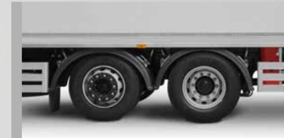
L'essieu arrière directionnel, disponible sur nos véhicules 9 l et 12,7 l à configuration d'essieu 6x2, améliore l'expérience de conduite en offrant une maniabilité optimale, même dans les rues les plus étroites.
