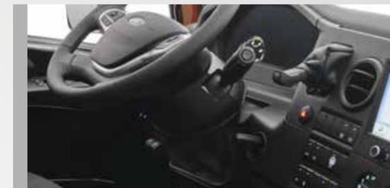
Les véhicules de 420 ch sont équipés d'une transmission automatique à 16 vitesses avec des modes de conduite distincts pour un mélange équilibré d'économies et de performances. Quant aux véhicules de 330 ch, ils sont équipés en option d'une transmission automatique à 9 vitesses. Cette fonction permet au véhicule de sélectionner automatiquement le rapport le plus approprié, maximisant ainsi les économies de carburant et les performances.
