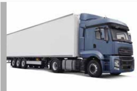
Un véhicule plus léger pour une plus grande capacité de charge utile. L'option de cabine à toit surbaissé réduit le poids global du véhicule, ce qui permet de transporter plus de charge. Les jantes en aluminium et les options de 5e roue sans graisse contribuent également à la réduction de poids.
