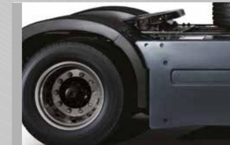
Les tracteurs 4x2 offrent une hauteur de 5e roue réglable de 980 mm à 1300 mm, vous permettant de choisir l'option la mieux adaptée à votre activité. Les tracteurs 6x4 ont des options de hauteur de 5e roue allant de 1350 mm à 1450 mm.
