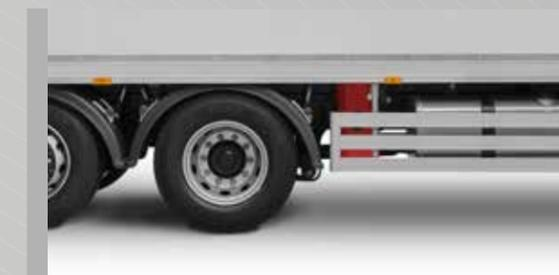
Sur les véhicules à configuration d'essieu 6x2 et 8x2, l'essieu arrière peut être relevé en option lorsque le véhicule n'est pas chargé. Cela évite l'usure inutile des pneus. Lorsque vous arrêtez le véhicule pour le charger, les pneus sont automatiquement abaissés grâce à la fonction Auto-Drop.
