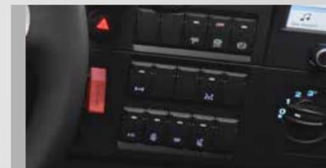
Rangement intérieur, commandes des vitres et des rétroviseurs
