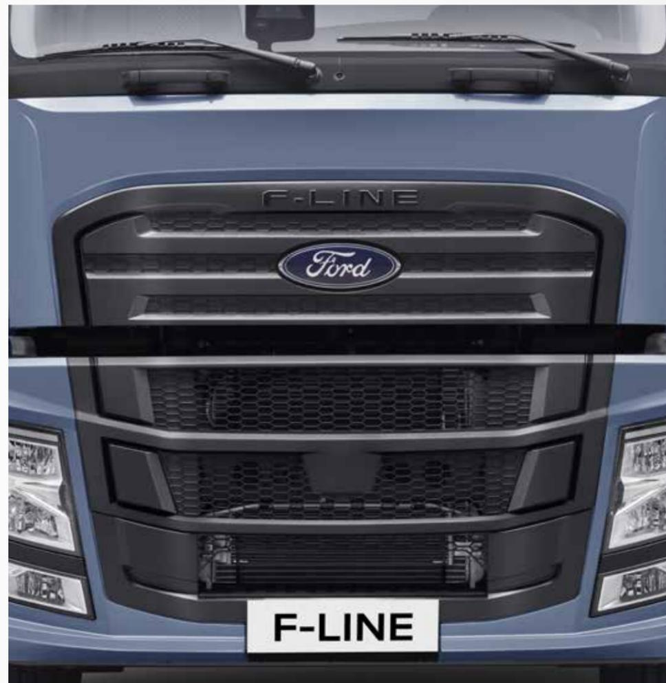
Le pare-chocs avant en plusieurs parties permet de ne remplacer que la partie endommagée, ce qui garantit des réparations rapides et des avantages en termes de coûts.
