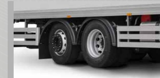
La suspension pneumatique arrière a été spécialement développée pour les modèles 4x2 et 6x2. Cette suspension non seulement offre un confort de conduite inégalé, mais permet également de transporter des charges conséquentes en toute sécurité.
